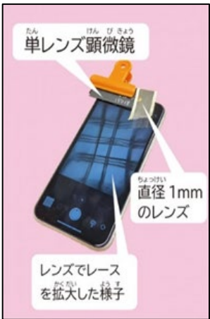
単レンズ顕微鏡をスマートフォンに取り付けた観察例
